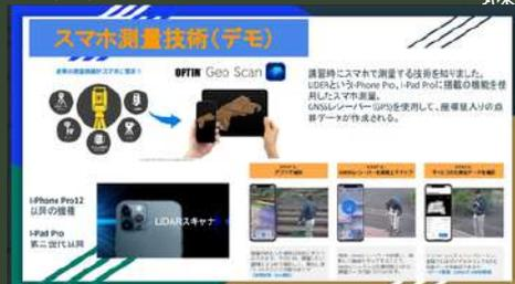
LiDERというiPhone Pro、iPad Proに搭載の機能を使用したスマホ測量を行った。GNSSレシーバー(GPS)を使用して、座標値入りの点群データが作成される。
